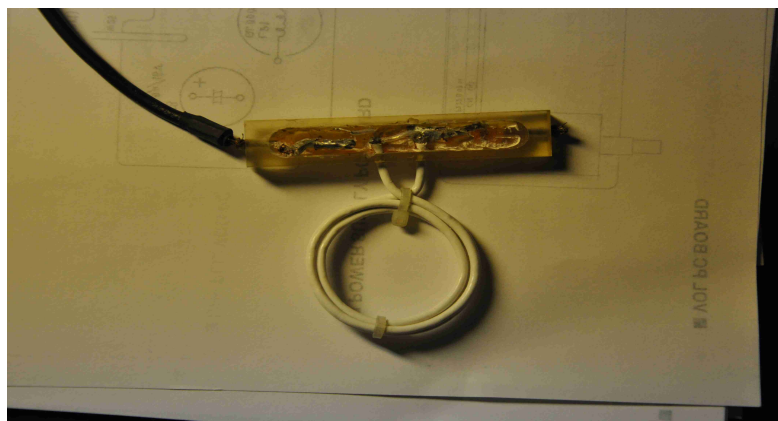
Abbildung 1: Defekter Sperrkreis mit bereits freigelegtem "Innenleben"
